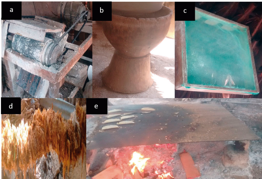
Figura 2. Equipos y utensilios artesanales utilizados en la elaboración del Casabito. a. Rallador eléctrico b. Pilón c. Cernidor d. Sebukán e. Buré
