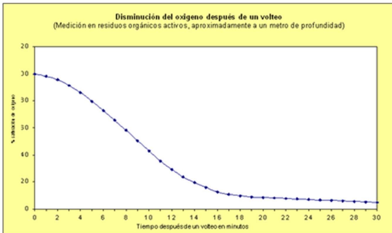
Figura 2. . Disminución del oxígeno después de un volteo
