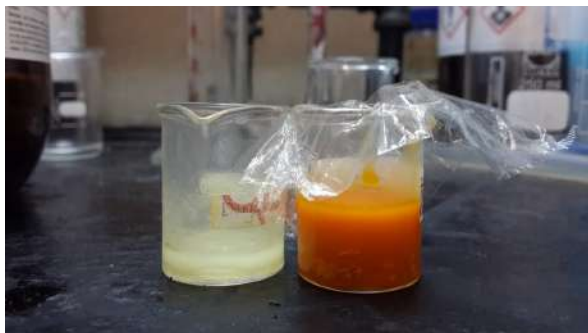
Figura 1. Resultado del proceso de blanqueamiento del aceite de palma mediante la utilización de la arcilla activada.
