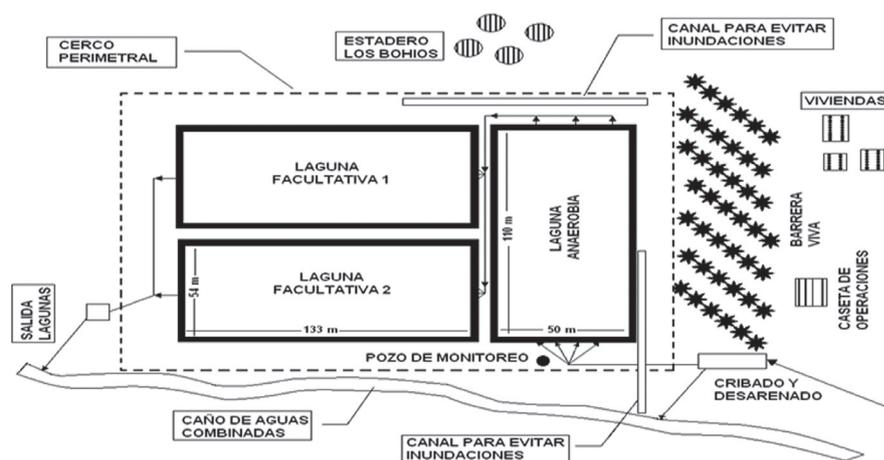
**Figura 1. Esquema general de la planta de tratamiento de aguas residuales del municipio de Santa Fé de Antioquia**
