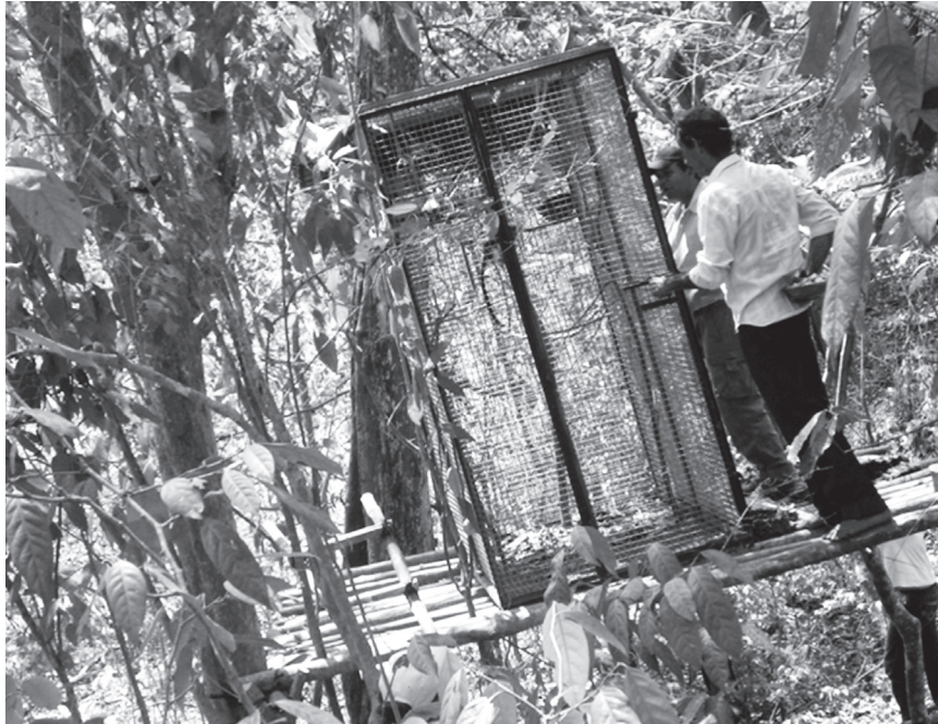
Foto 1. Jaula de inmersión en el bosque sobre la plataforma. (Bosque La Montañita, Vereda Ceiba Pareja, Lorica Córdoba)
