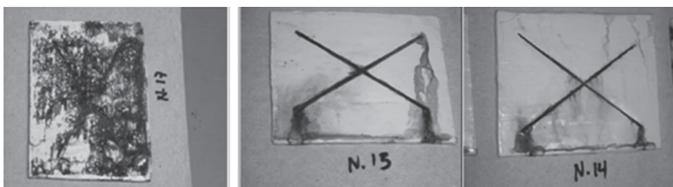
Figura 2. Resultados del ensayo de cámara de niebla salina
