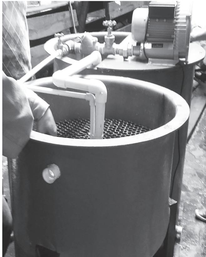
**Figura 2. Sistema de tratamiento de lodos activados**
