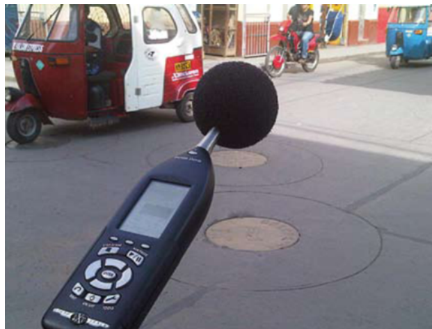
Figura 1. Sonómetro Larson Davis modelo 831 clase 1, utilizado.
